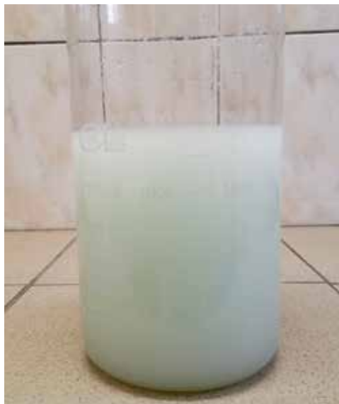
Przed sporządzeniem mieszaniny zbiornikowej należy wykonać test kompatybilności fizycznej
